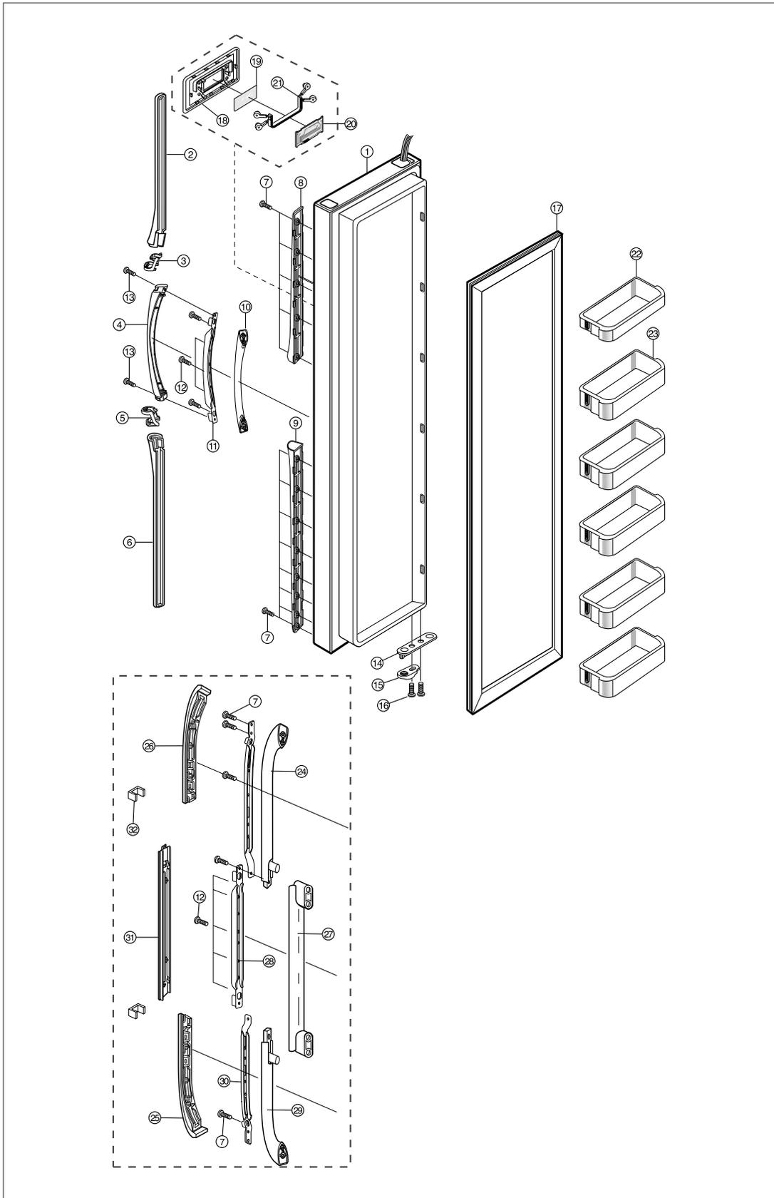
14-7) Vue éclatée de la porte du réfrigérateur (SR-S2026, S2028, S2226, S2228/S20NTC,S20DTC,S22NTC,S22DTC)
