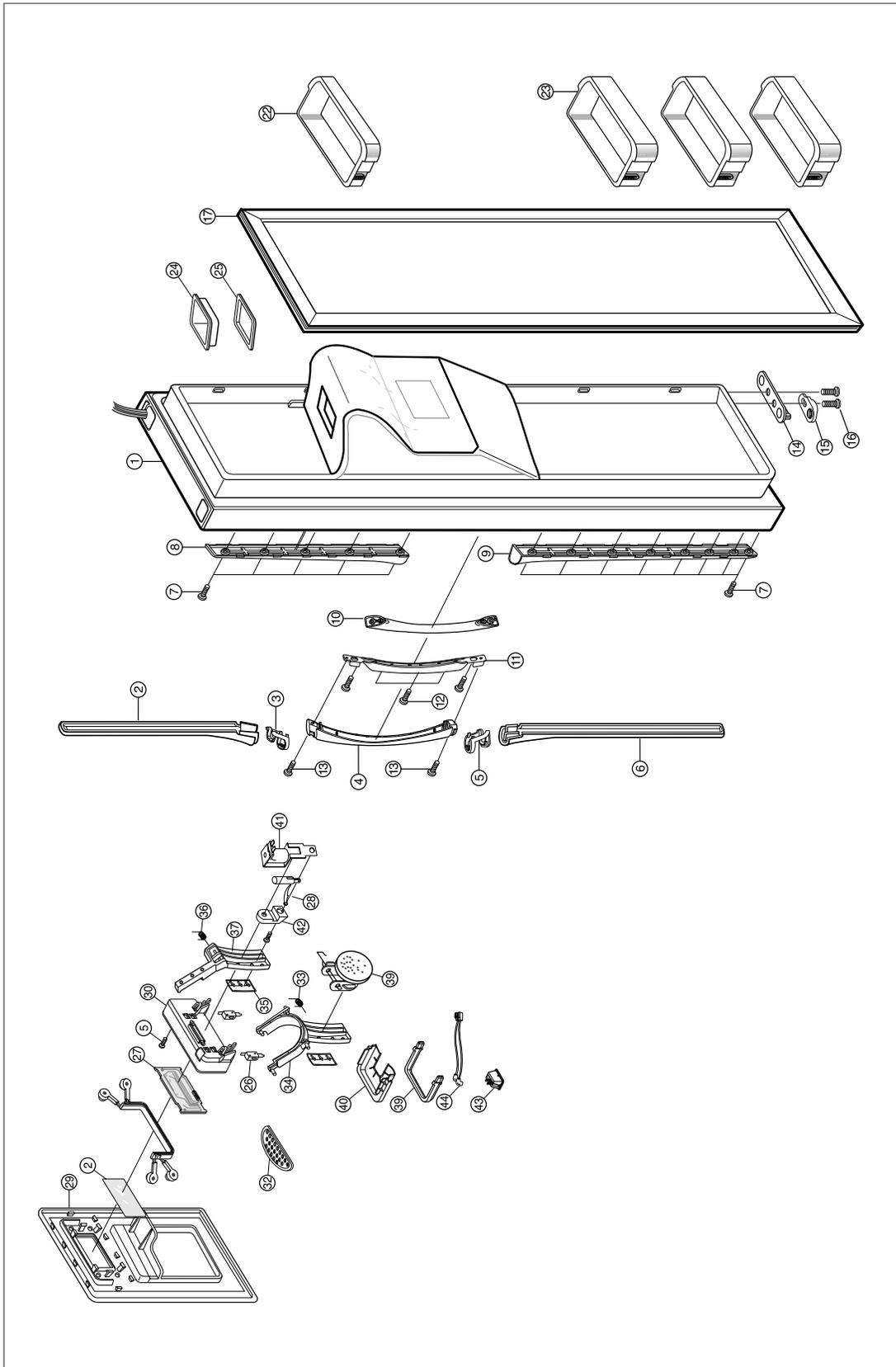
14-9) Vue éclatée de la porte du réfrigérateur (SR-S2027,S2029, S2227,S2229/S20FTC,S22BTC,S22FTC)
