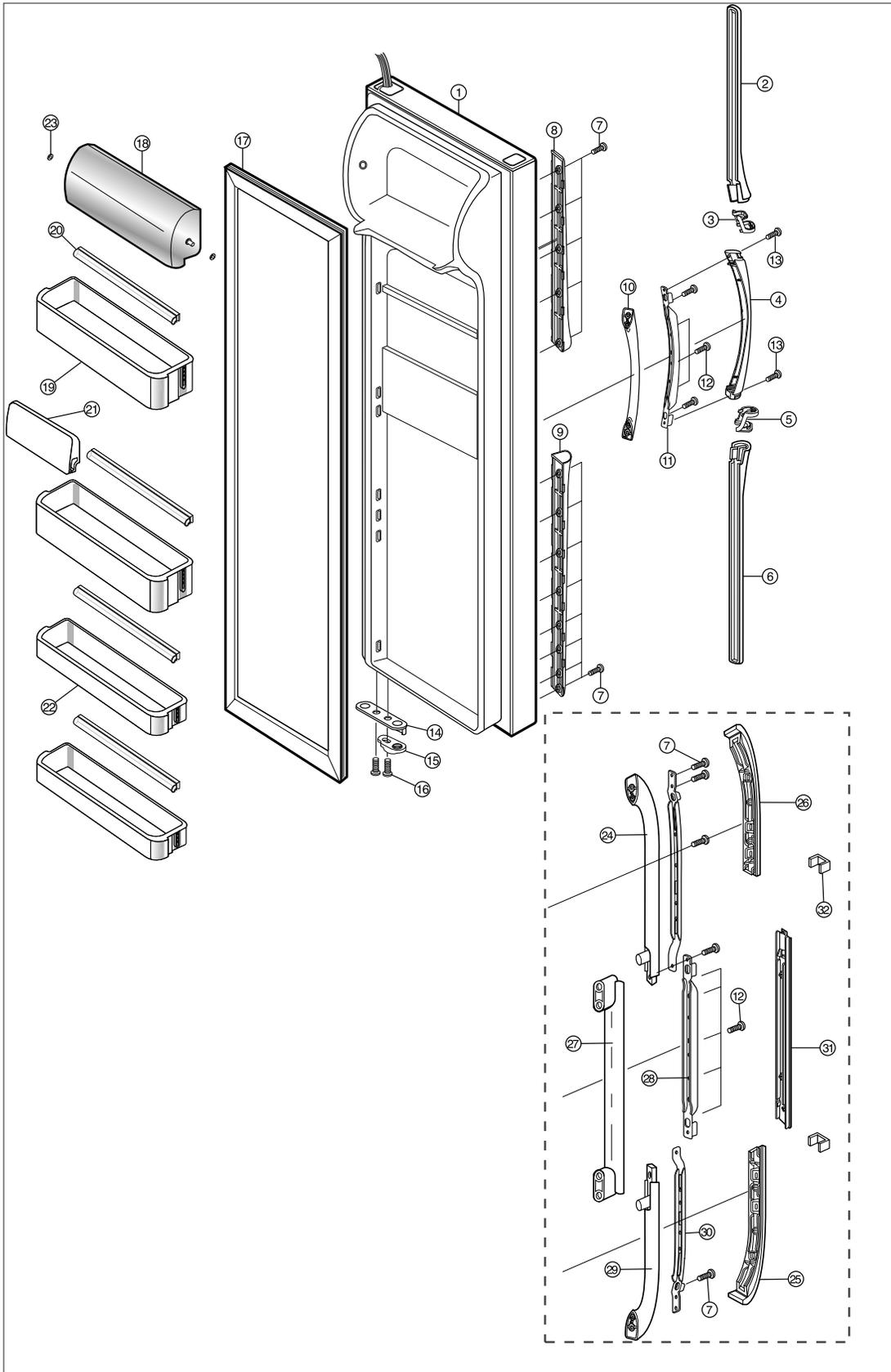
14-8) Vue éclatée de la porte du congélateur (SR-S2028, S2029, S2228, S2229/S20DTC,S20FTC,S22DTC,S22FTC)
